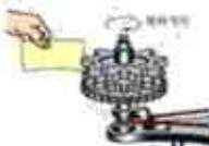
硬纸板接触齿数不同的齿轮
