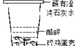
探究鸡蛋壳的成分-----根据石灰水变浑浊推测鸡蛋壳里可能含有碳酸钙
