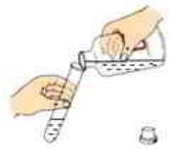
向试管中倾倒液体
