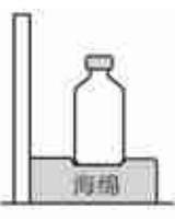
瓶发生形变产生的力改变了海绵的形状
