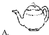
喝水使用的茶壶利用了连通器原理
